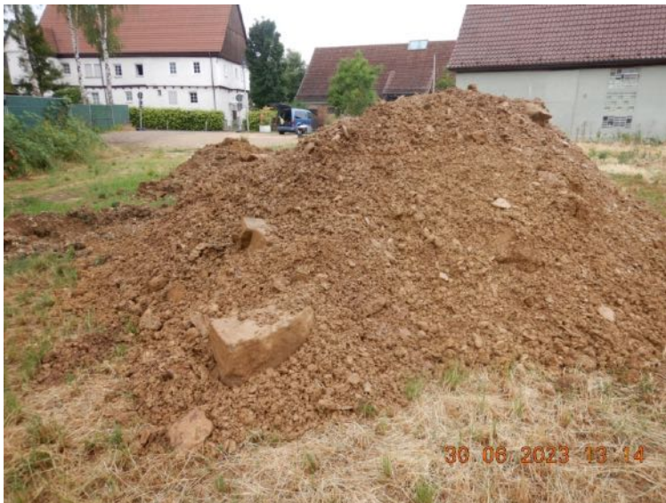
Aushub BS 01 - Filskiese mit Blöcken
